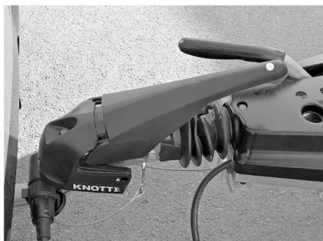
Fig. 10: Kuglekobling lukket, stabilisering aktiveret
