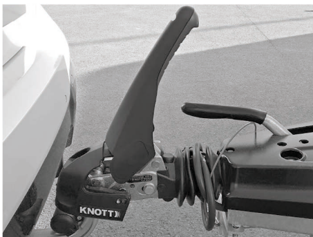
Fig. 9: Kuglekobling lukket, stabilisering deaktiveret
