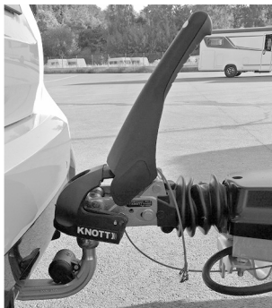
Fig. 13: Kuglekobling åben, stabilisering deaktiveret
