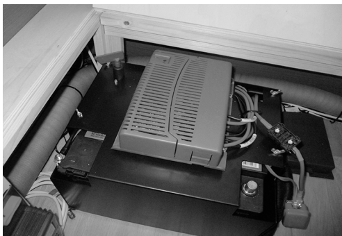
Fig. 70: Batteriafdækning med styreenhed til Mover (ekstraudstyr)
