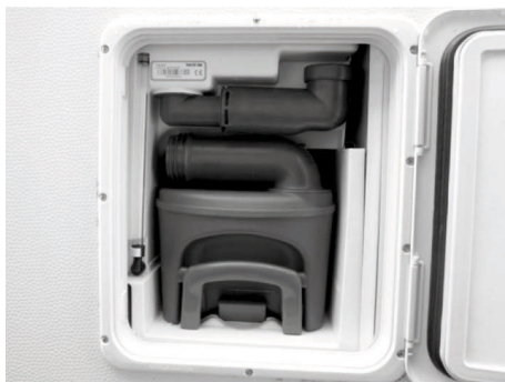
Fig. 57: Toilettank med påfyldningsstuds til skyllevand
