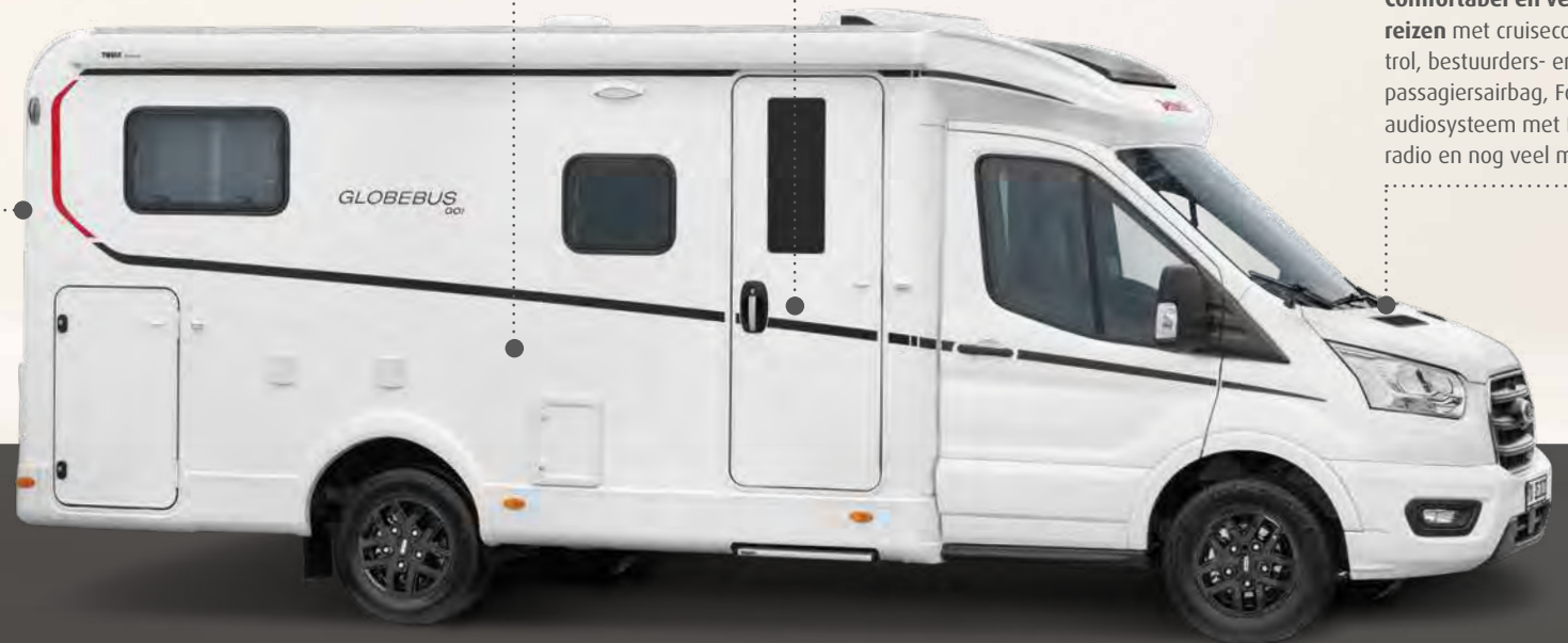
Dak, achterzijde en zijwanden van sterk GFK-materiaal.
